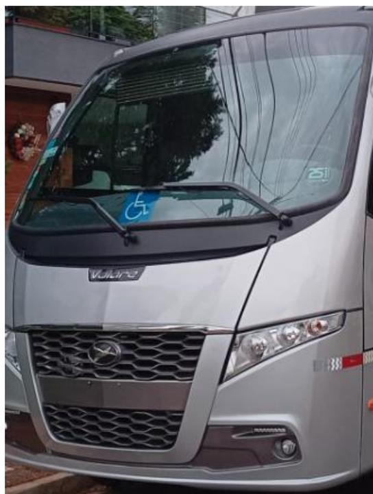
Salienta-se, ainda, que para-brisas instalados de forma bipartida utilizam uma tecnologia ultrapassada de fixação, que podem ocasionar infiltração de água na coluna central, que, com o passar do tempo, poderá ser danificado, apresentando ferrugem e ocasionado pelo acúmulo de água, poeira e outros fragmentos. Além disso, o para-brisa inteiro possui baixo custo de manutenção.
