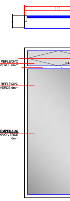
J08 DETALHE - PLANTA DIMENSÃO: 5,05X2,50m SISTEMA: BASCULANTE/FIXA/ABRIR MATERIAL: ALUMÍNIO QUANTIDADE: 01 UNIDADE ESC. 1:25
