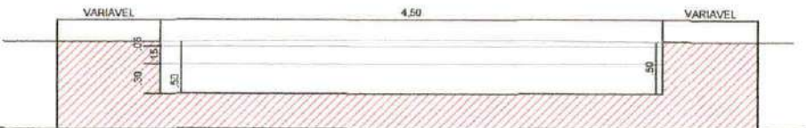
CORTE DO LEITO DA RUA TERRAPLANAGEM ESCALA 1-50
