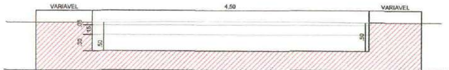
CORTE DO LEITO DA RUA TERRAPLANAGEM ESCALA 1-50
