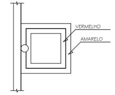
**DETALHE EXTINTOR DE PAREDE**
